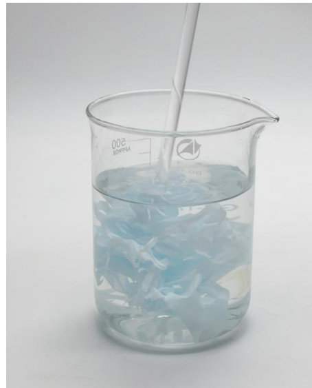
常溫水攪拌破裂
