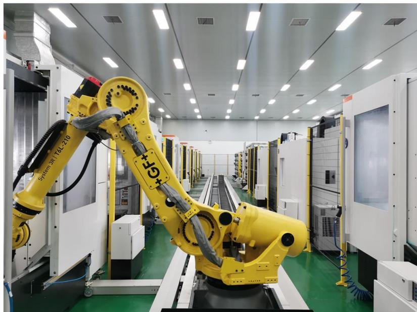
圖 109：混合自動化線加工鋼料
