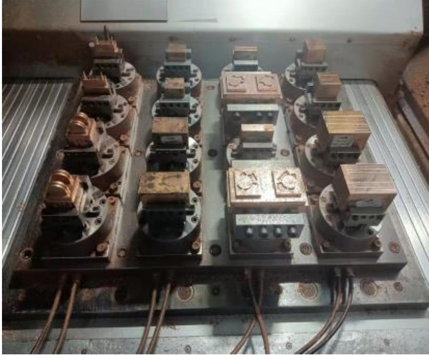
圖 65：健大多銅工電極 CNC 加工
