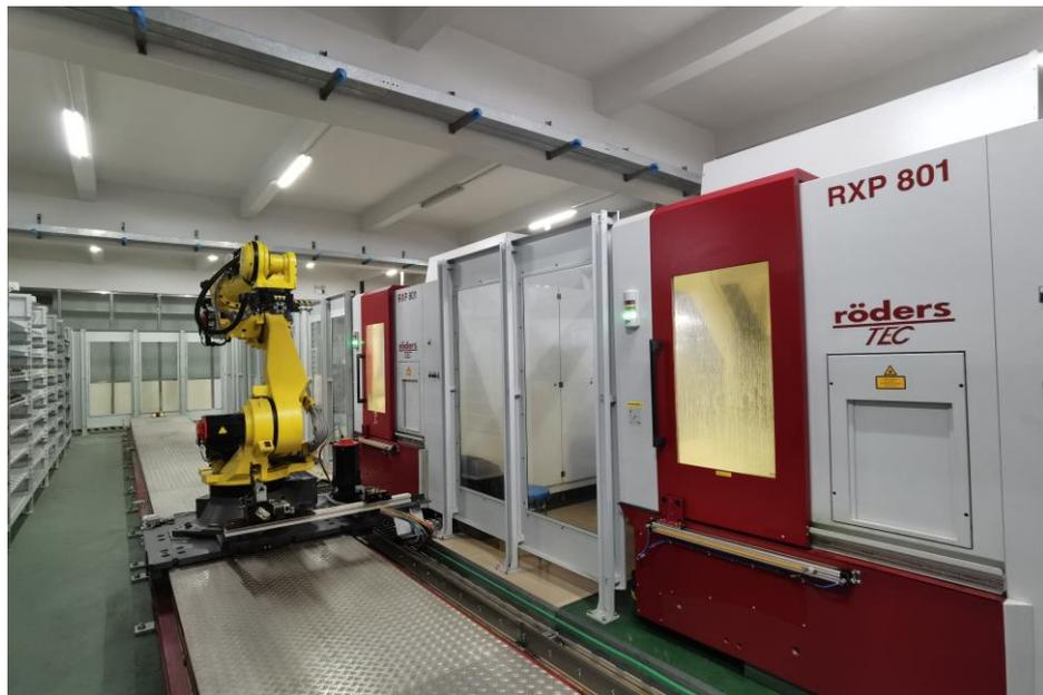
圖 80：信興銅工加工自動化
