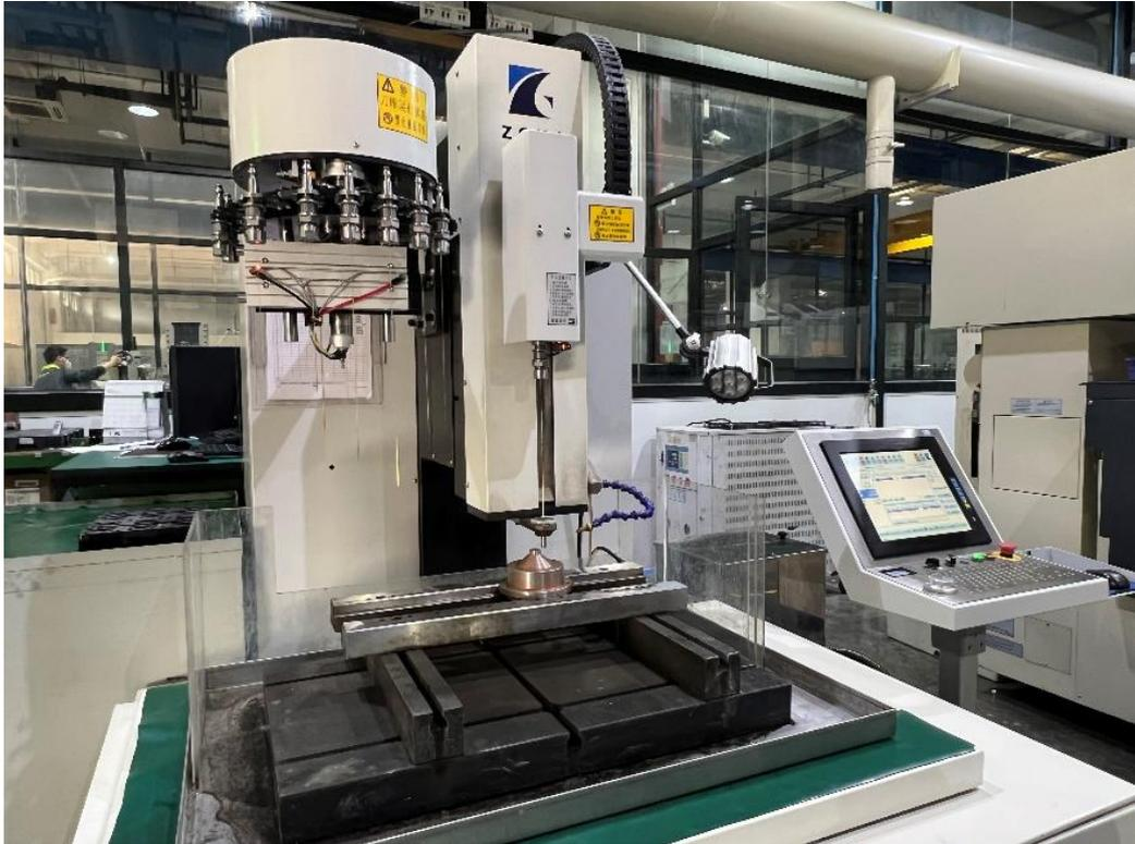
圖 52：線切割自動換刀系統
