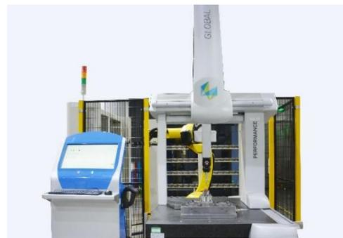
圖 50：電極自動化測量
