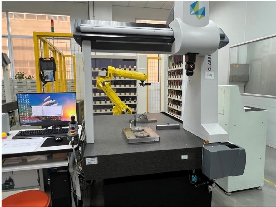
圖 102：力嘉三坐標測量自動化
