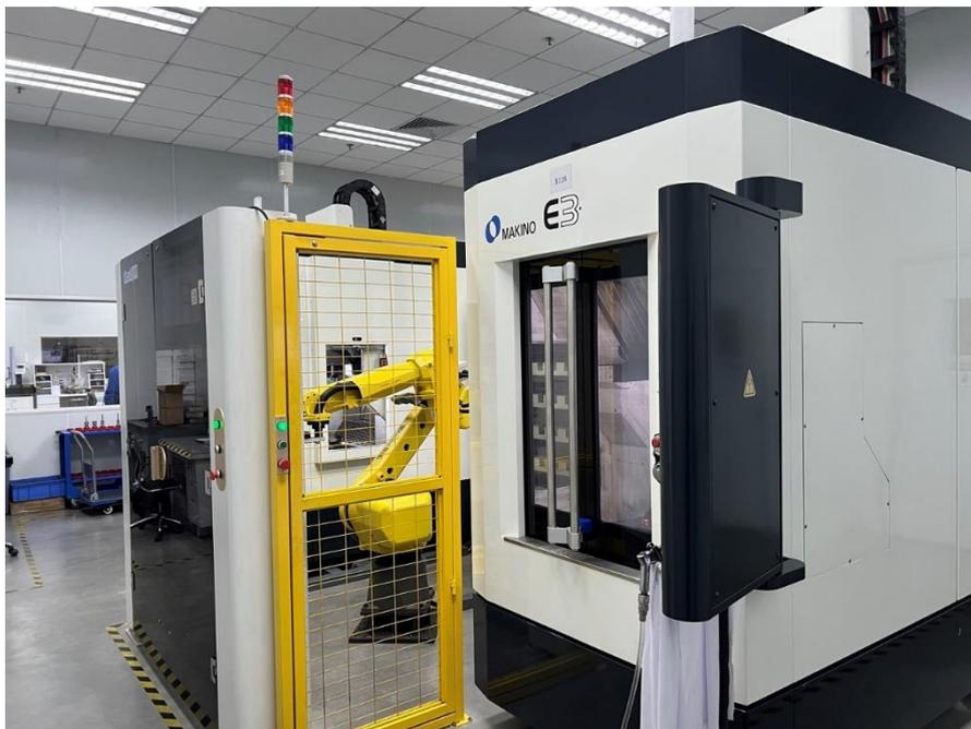
圖 101：力嘉石墨電極加工自動化
