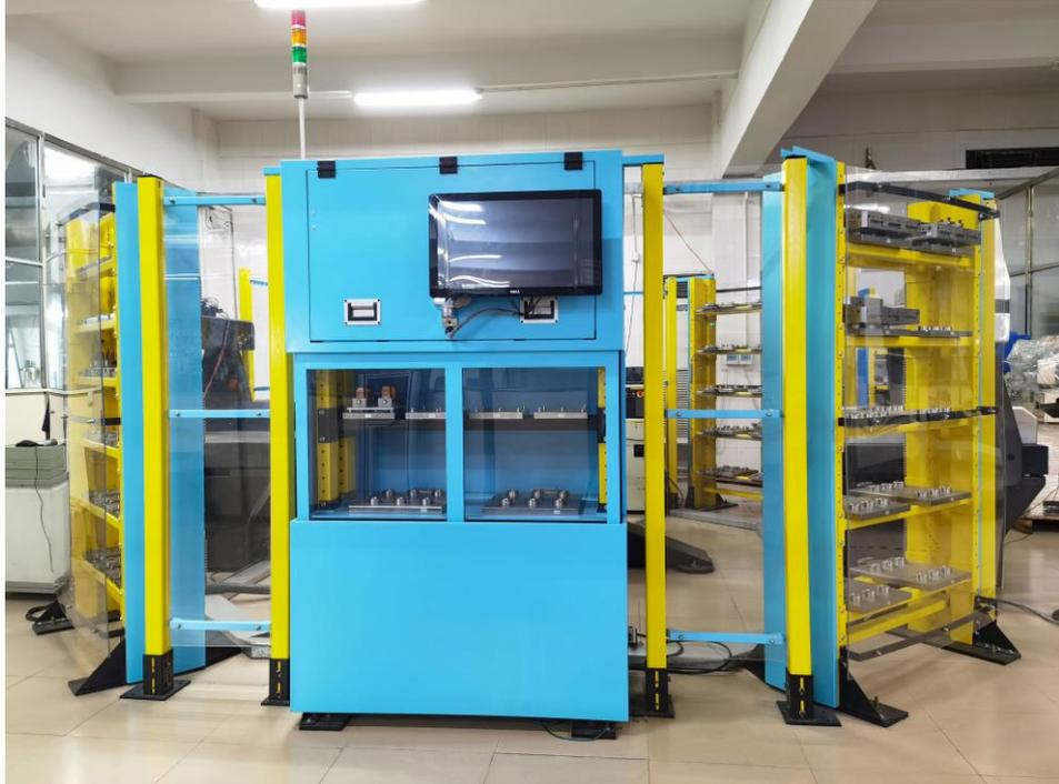
圖 79：信興電極三坐標測量自動化
