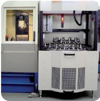
圖 36：工件更換系統
