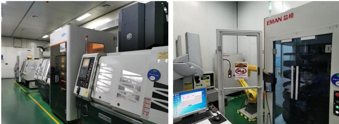
圖 108：石墨電極自動化加工及自動化測量單元
