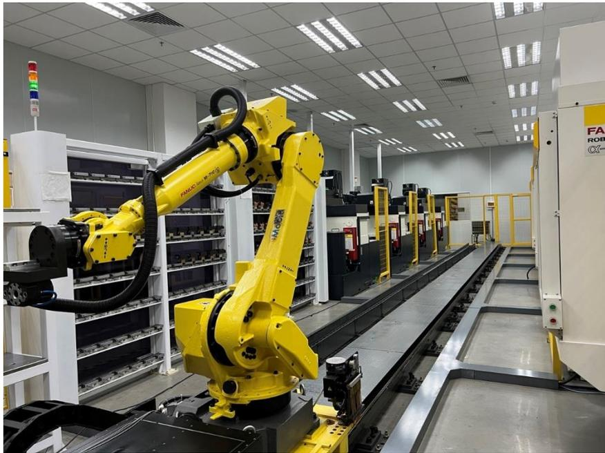
圖 100：力嘉多加工中心自動化，結合 CNC 與火花機自動化
